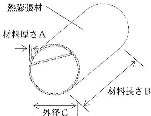
図1 熱膨張材の形状
